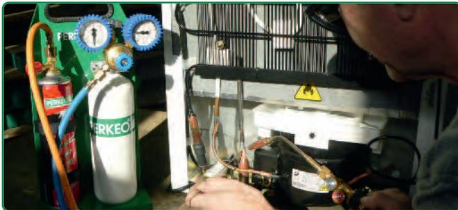
An Wuchse klein und winzig, an Leistung riesengroß – an diesen Leitspruch hält sich das neu entwickelte M-Gas-Sauerstoff Hartlötgerät MINI ECO. Durch die Verwendung der Power-Gaskartusche mit Spezial-Gasgemisch aus Methyl, Acetylen und Propan (vgl. M-Gas) in Kombination mit Sauerstoff bringt es das MINI ECO auf eine Flammentemperatur von über 3.000°C! Das entspricht nahezu der Flammentemperatur beim Autogenschweißen (3.150°C).
